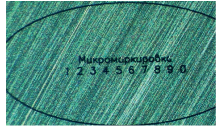
Рис. 3. Микромаркировка по полированному кремнию, высота букв – 50 мкм
